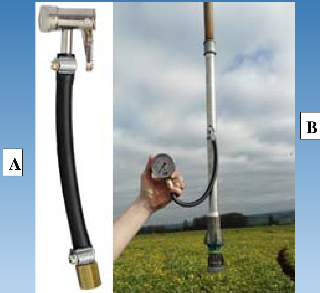
Figura 8 – Mangueira flexível com Trava (A). Técnica de medição de pressão utilizada (B).
