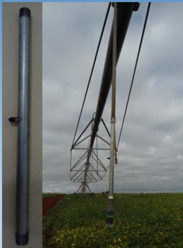
Figura 2 – (A) Válvula adaptada ao tubo de descida para estimar a pressão. (B) tubo de descida acoplado ao pivô central.
